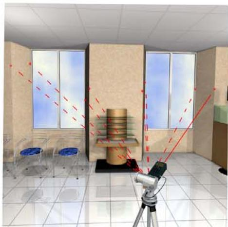
Avec le **TRIPOD** pour faire un relevé, il suffit de viser les angles de la pièce ou les murs, à n'importe quelle hauteur, sans se déplacer !
