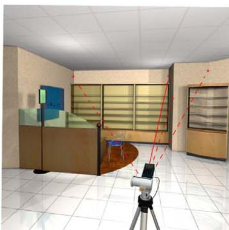
Le **TRIPOD** permet de s'affranchir des obstacles en faisant des visées "au plafond".
