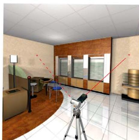
Si un coin de la pièce n'est pas visible, il suffit de viser directement sur les murs, le **TRIPOD** "reconstitue" l'angle
