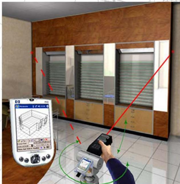
Le **TRIPOD** est un théodolite électronique équipé d'un télémètre laser.
